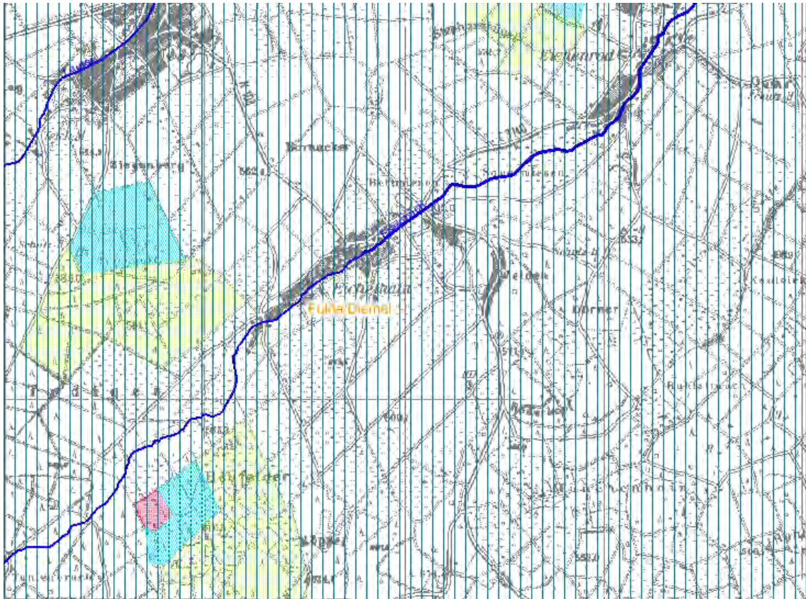
Abb. 2-14: Wasserschutzgebiet im Bereich Eichelhain rot: WSZ I, blau: WSZ II, grün, WSZ III
