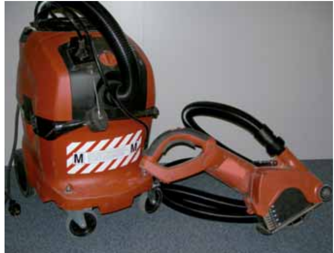
Abgestimmtes System: Mauernutfräse mit Entstauber der Klasse M
