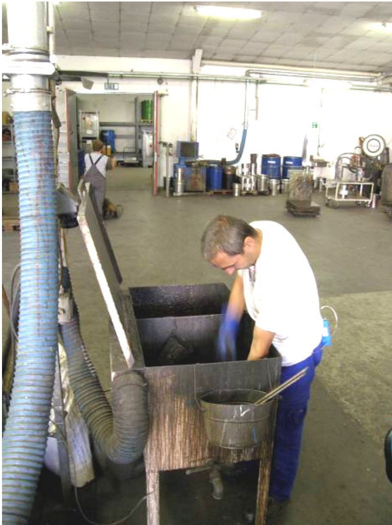
ABBILDUNG 13: REINIGUNG VON KLEINTEILEN AM REINIGUNGSBECKEN MIT RANDABSAUGUNG
