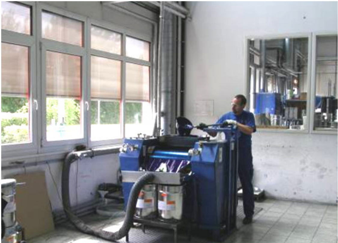
ABBILDUNG 6: ARBEITEN AN EINEM ABGESAUGTEN WALZENSTUHL
