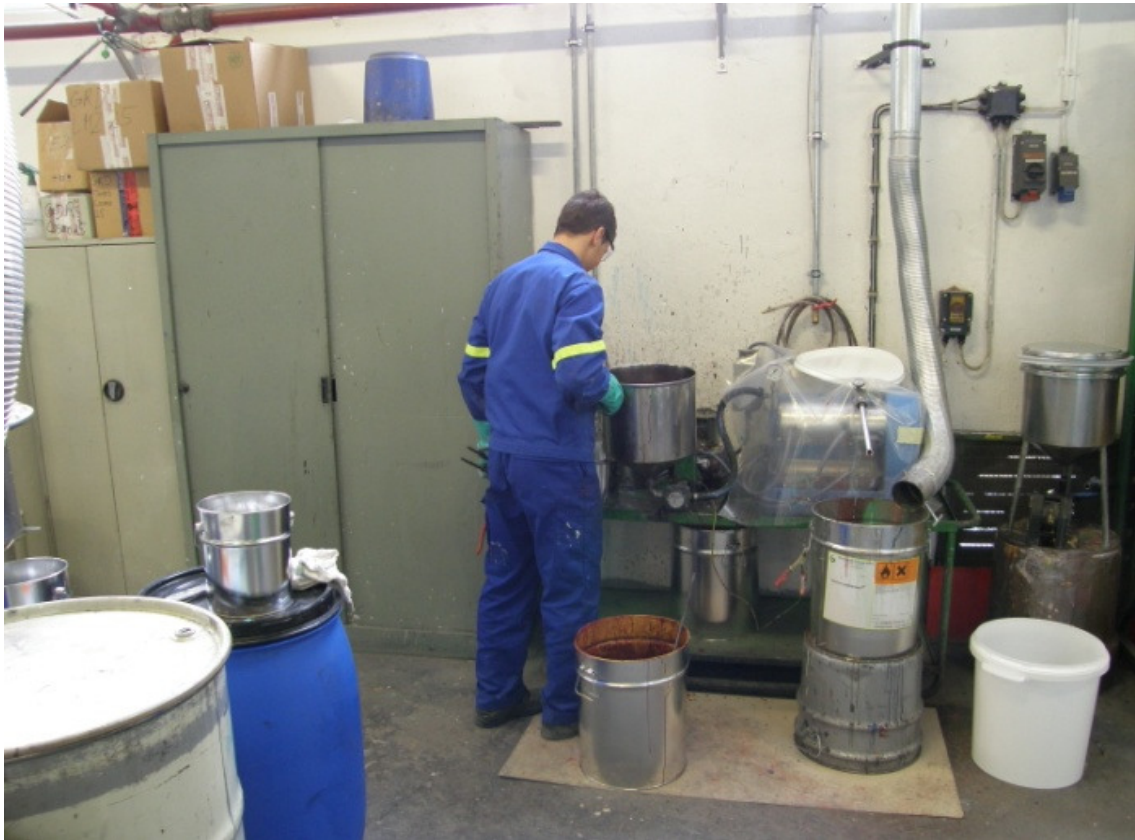
ABBILDUNG 5: EINSATZ EINER PERLMÜHLE BEI DER HERSTELLUNG EINER KLEINCHARGE
