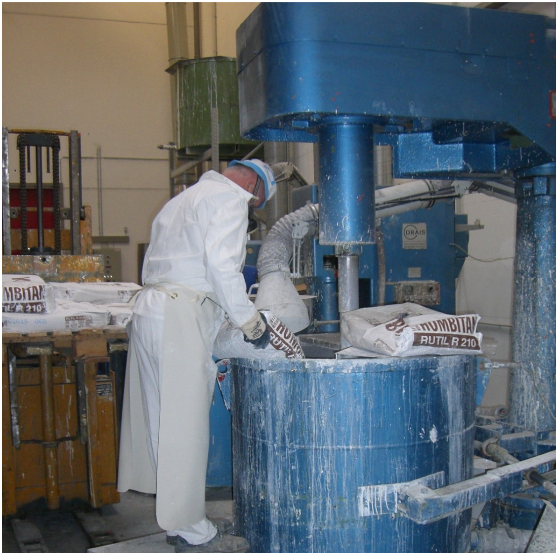
ABBILDUNG 4: BEFÜLLEN DES ANSATZBEHÄLTERS MIT FESTSTOFF
