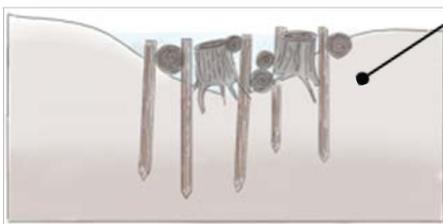
Fixierung mit eingerammten Holzpählen und mit Drahtseil an Erdankern.
