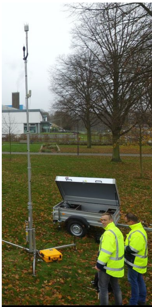
Abbildung 17: Lärmmessung mit Messanhänger. © RP Gießen
