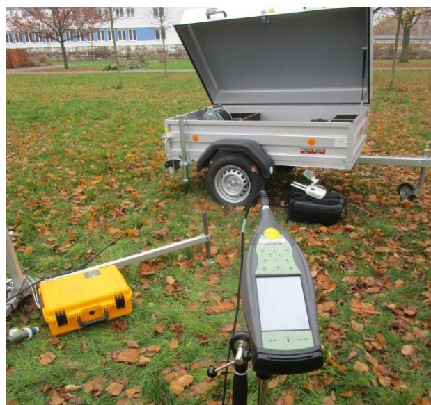
Abbildung 16: Lärmmessung mit Messanhänger. © RP Gießen
